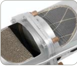
1.4509/441 kalite, dizel parçacık filtresi, Peugeot 607, Faurecia
